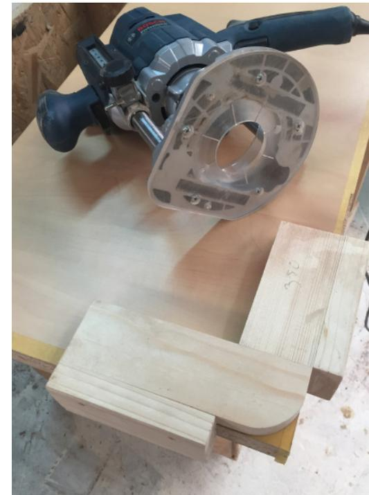
Les congés sont réalisés à l'aide d'une défonceuse et d'un gabarit
