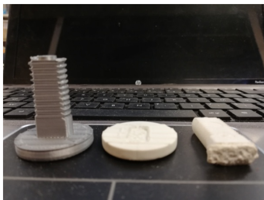
Figure 7 - Photos des vis d'un pied de planche de bain INVACARE. Sur chaque photo : à gauche la vis imprimée et à droite la vis INVACARE cassée
