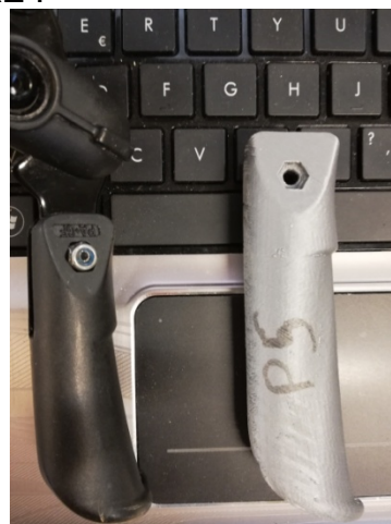
Figure 16 - Comparaison de deux poignées de frein d'un fauteuil roulant manuel, l'une imprimée l'autre provenant du fabricant INVACARE - source : 2V2C
