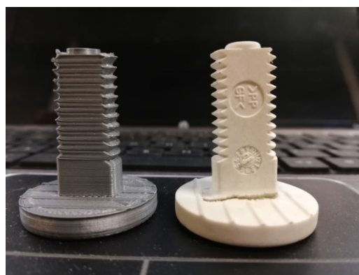
Figure 7 - Photos des vis d'un pied de planche de bain INVACARE. Sur chaque photo : à gauche la vis imprimée et à droite la vis INVACARE cassée
