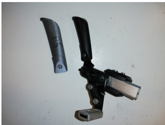
Figure 16 - Comparaison de deux poignées de frein d'un fauteuil roulant manuel, l'une imprimée l'autre provenant du fabricant INVACARE - source : 2V2C
