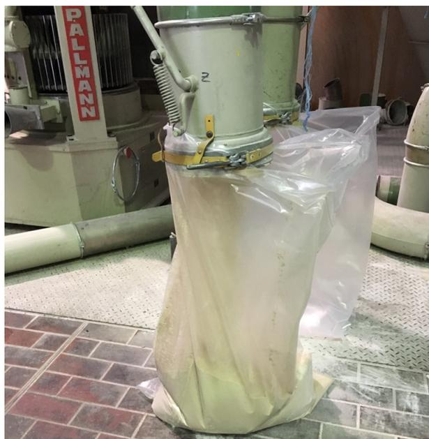
Figure 13: Mise en sacs du composite PE20-4 micronisé
