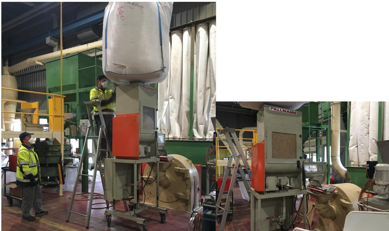
Figure 4 : Chargement et dispositif d'alimentation du broyeur PSKM
