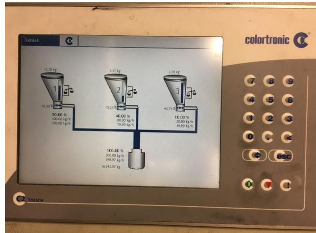
Figure 9 : Dispositif de dosage pondéral 3 voies (Colortronic) et système de commande
