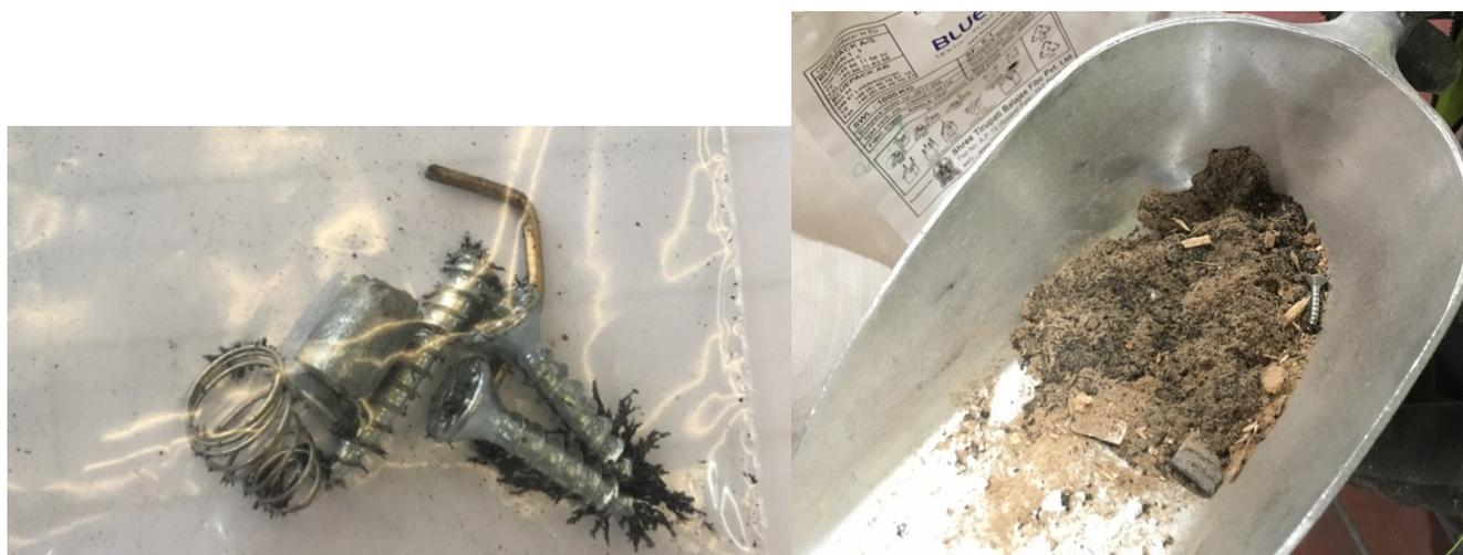
Figure 5 : Exemples de pièces métalliques trouvées sur les plaques aimantées du broyeur (à G) et lors du tri manuel (à D)
