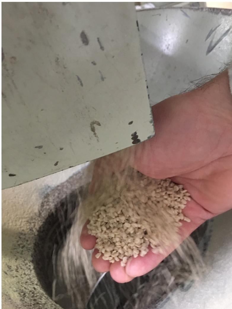
**Figure 10 : Prise d'échantillon de compound WPC au niveau de la mise en sacs en ligne**
