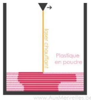
Comparé aux autres méthodes de fabrication additive telles que la stéréolithographie (SLA) et le dépôt de fil/filament fondu (FDM- FFF), le SLS ne nécessite pas de structure support : la poudre agit elle-même comme un support. Cela permet de construire des modèles aux géométries complexes et imbriquées.
