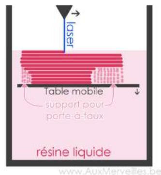
Les pièces fabriquées à l'aide de ce procédé ne sont pas aussi résistantes que celles réalisées en SLS ou FDM (cf ci-après). En revanche, le rendu des détails est meilleur et
