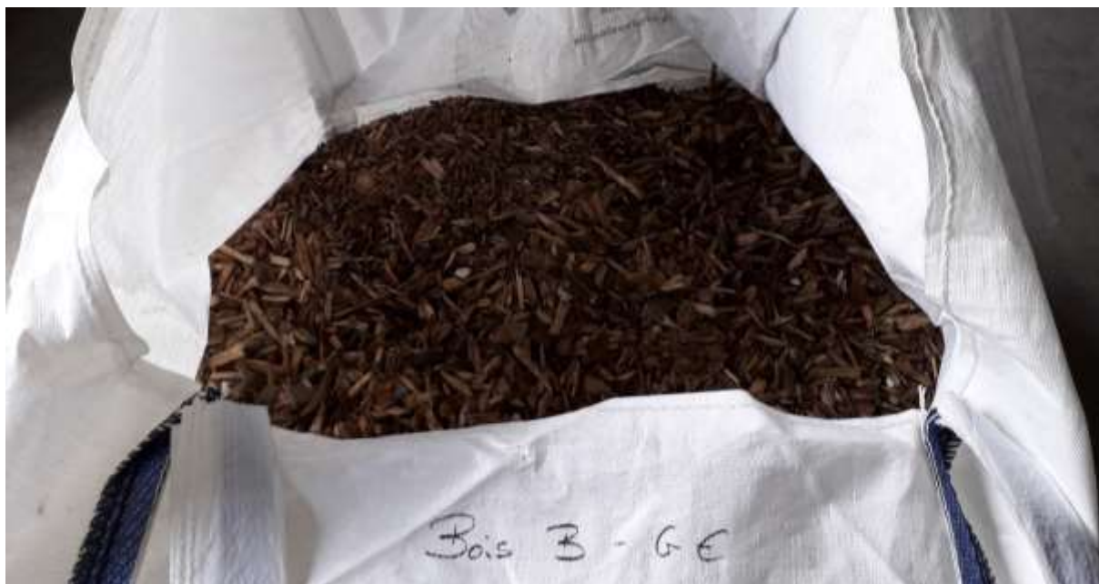
Figure 2 : Résultat de la préparation de l'échantillon de bois B – « Guyot Environnement »
