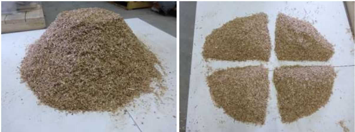
Figure 6 : Photo de l'échantillonnage par quartage, réalisée à l'IMT Lille Douai, sur les 4 échantillons de bois B.
