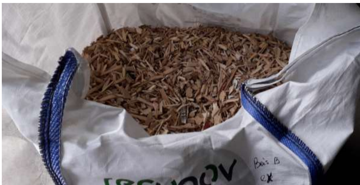
Figure 3 : Résultat de la préparation de l'échantillon de bois B – « Excoffier »
