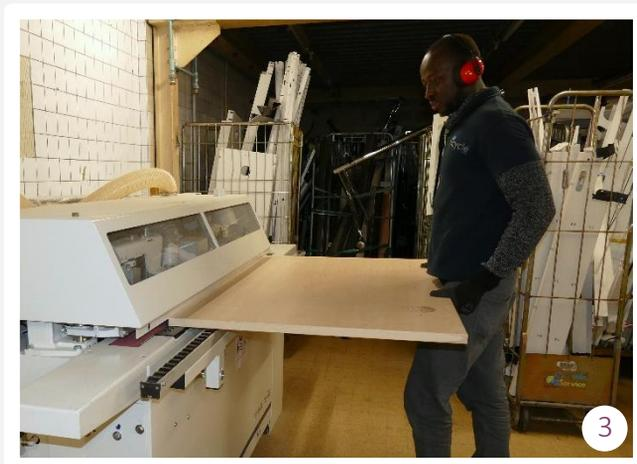
4. Couper le chant à l'aide d'un araseur de chant pour adapter parfaitement le chant au panneau
