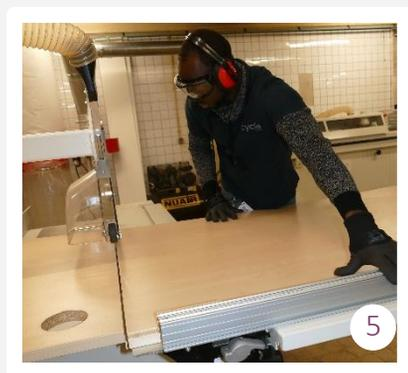
6. Aspirer des copeaux dans les sacs de récupération à l'aide du groupe d'aspiration placé à côté de la scie
