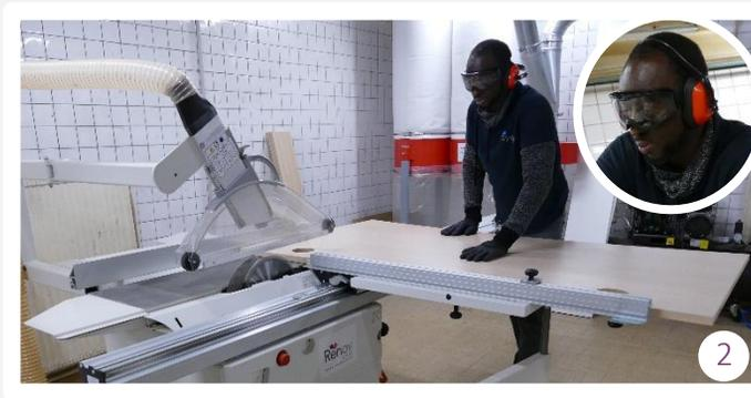
3. Fixer la planche avec la butée de réglage pour déterminer les côtes
