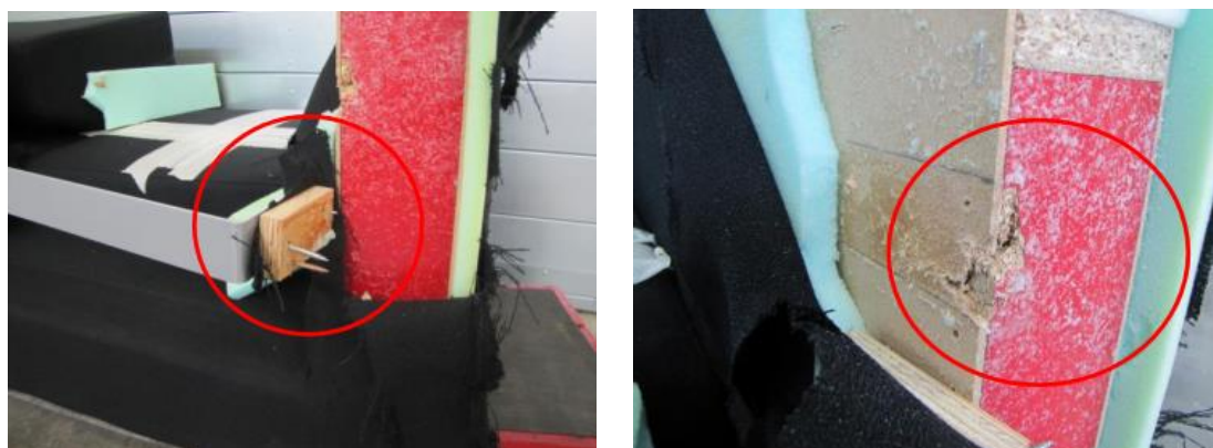
Figure 5 : Rupture à la liaison accotoir/dossier sur OXEL 2 places
