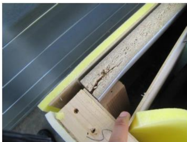
Figure 6 : Rupture à la liaison accotoir/dossier sur PUNTA 3 places
