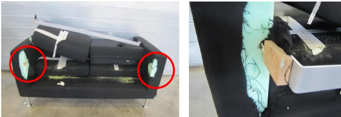
Figure 7 : Rupture à la liaison accotoir/dossier sur OXEL 2 places
